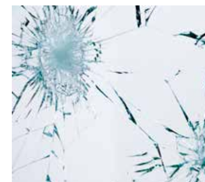
Lepené bezpečnostní sklo se ani při působení násilí nerozpadne a okno zůstane uzavřené.
