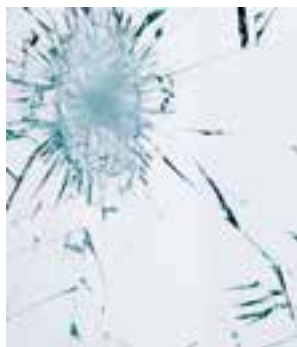
Bezpečnostní zdvojené sklo se nerozpadne ani při použití násilí.
