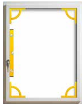
Svařený profil křídla se pravouhlo vyrovná.
