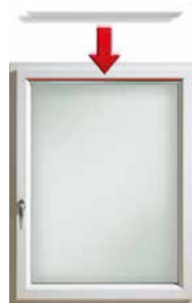
Osazením zasklívací nebo krycí lišty se začistí lepená spára.
