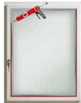
Zbýlá spára mezi sklem a rámem se celoodvodově vyplní lepidlem.
