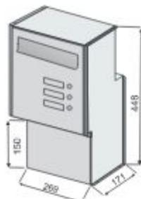
Schránka určená pro nazdění do zdi nebo plotového sloupu z tvarovek PlayBlok III
