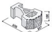
GEOSTONE®- BENT tříčtvrták štípaný
