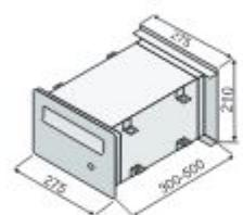
Schránka určená pro nazdění do zdi nebo plotového sloupu o tloušťce 300-500 mm
