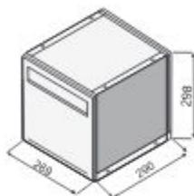
Schránka určená pro nazdění do plotového sloupu z tvarovek PlayBlok III šíře 300 mm
