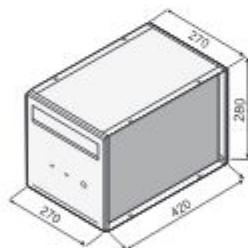
Schránka určená pro nazdění do plotového sloupu z tvarovek Lidovka
