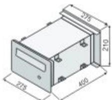
Schránka určená pro nazdění do zdi nebo plotového sloupu o tloušťce 400 mm
