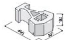
GEOSTONE® - BENT tříčtvrták hladký
