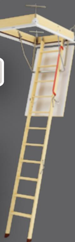
Půdní schody LWZ Plus spojují výhody nové konstrukce se systémem rychlé montáže. Ocelový rám, který využívá dřevěnou skříň, společně s integrovanými montážními úhelníky a kovovými krycími lištami usnadňují montáž a zkracují čas potřebný k osazení schodů ve stropě.
