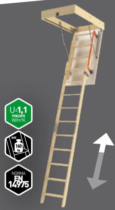
Půdní schody **LDK** jsou dvoudílné. Spodní segment se posouvá vůči hornímu dílu. Díky tomu je možné eliminovat maximální vzdálenost při rozkládání skládacích schodů. Nová konstrukce posuvného segmentu, který je složený ze dvou dílů, výrazně změnuje rozměry balení a usnadňuje přepravu výrobku.
