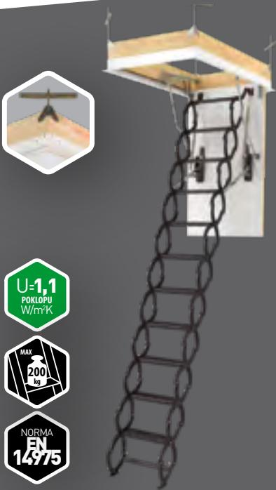
Stahovací půdní schody **LST** jsou vybaveny bílým zatepleným poklopem, dřevěnou skříní, kovovými krycími lištami a montážními úhelníky. Stahovací konstrukce umožňuje složit žebřík na malé rozlohy, díky čemuž lze schody namontovat do malých půdních otvorů (nejmenší rozměr je 50x80 cm).
