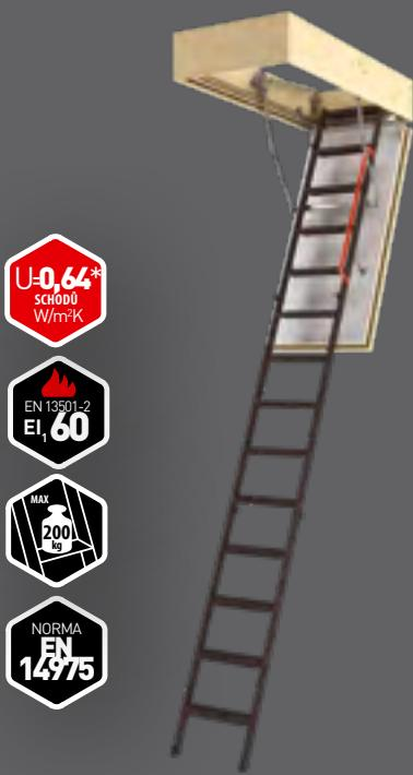
Protipožární půdní schody nové generace **LMF 60** jsou vybaveny kovovým žebříkem. Zaručují vysoký stupeň požární ochrany a také komfortní a bezpečný přístup do půdních prostor. Třída požární odolnosti schodů **LMF 60** je  $EI_1/EI_2 = 60 \text{ min}$  (klasifikace dle EN 13501-2), ze strany místnosti, ve které byly instalovány. Jsou dostupné rovněž ve verzi pro vysoké stropy - max. výška 360 cm.
